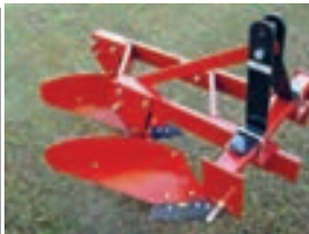
شکل ۳-۳- انواع گاو آهن برگردان از نظر تعداد خیش
