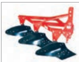
شکل ۳-۳- انواع گاو آهن برگردان از نظر تعداد خیش
