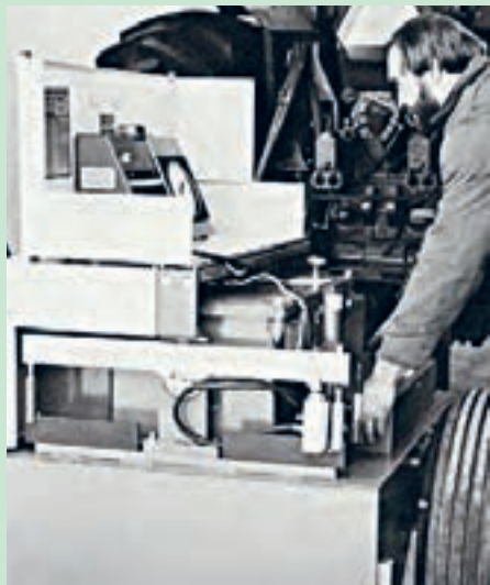
شکل ۳۵-۳- اندازه‌گیری توان یک تراکتور با دینامومتر
