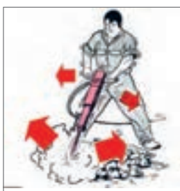
شکل ۳-۱- کارگرانی که با دژبر کار می کنند در معرض ارتعاش هستند
