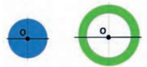
شکل ۳۲-۴- ممان اینرسی قطبی برای دو سطح مقطع متفاوت
