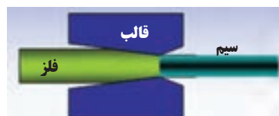
شکل ۲۵-۵- تولید سیم به روش کشش
