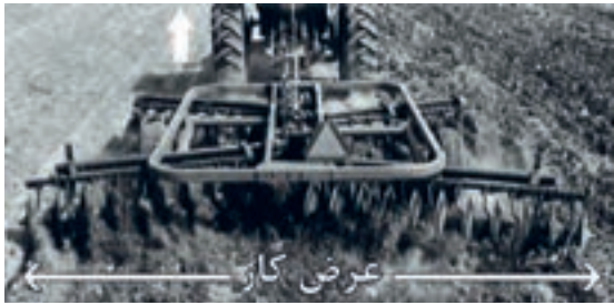
شکل ۴-۳ عرض کار ماشین
